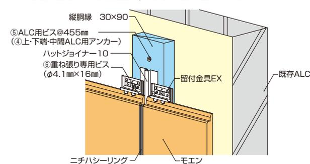
留付金具EX を使用し重ね張り工法用留付金具専用ねじ (JK1130) で留め付けてください。
