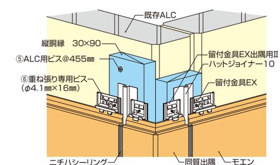
留付金具EX を使用して同質出隅を施工してください。
