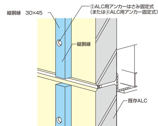
木胴縁の上端下端部および中間部は座堀をしてから指定の ALC 用アンカーで留め付けてください。
