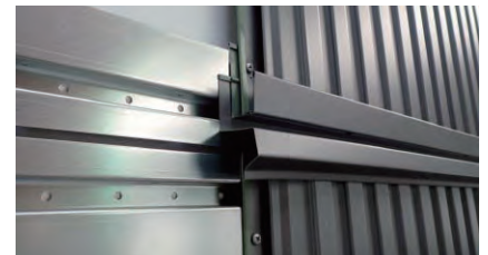
上下接合部には金属胴縁15接合部用(KN2060)を使用して施工してください。
