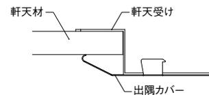
出隅カバー・勾配出隅カバー部分への軒天材の施工はK□M2N本体と軒天受けの間に軒天材を差し込んでください
