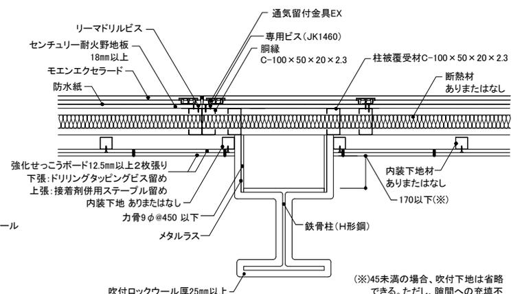
(※)45未満の場合、吹付下地は省略できる。ただし、隙間への充填不足を防ぐために、吹付工事が確実に行われていることを確認してください。
