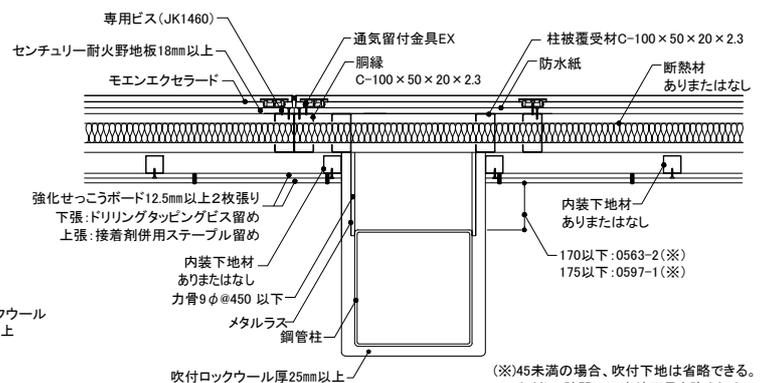
(※)45未満の場合、吹付下地は省略できる。ただし、隙間への充填不足を防ぐために、吹付工事が確実に行われていることを確認してください。
