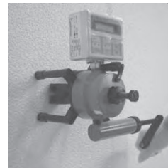
【推奨試験機】 サンコーテクノ株式会社 テクノテスターRT-2000LD(Ⅱ) (日本建築工学会認定)
