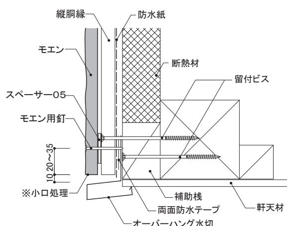
**小口処理** モエン縦張り下端小口面および切断小口面は、モエンシーラーを十分塗布し乾燥後、切断小口面が見える部分については専用補修液を、それ以外の部分はモエンシーラーを塗布します。
