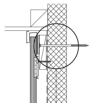
**X** モエン上端部の金具留めされている胴縁の下地(補助棟・横棟)がない。
