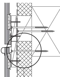
**X** モエン上端部の金具留めされている胴縁の下地(補助棟・横棟)がない。
