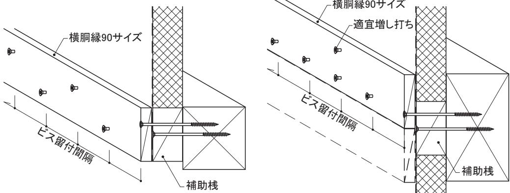
⑥サッシ上部の補助桟寸法およびビス留付間隔は、支持するモエンの長さが1000mm以下の場合は、横桟同等で可とします。(45mm幅以上の桟で、ビス留付間隔455(500)mm以下)
