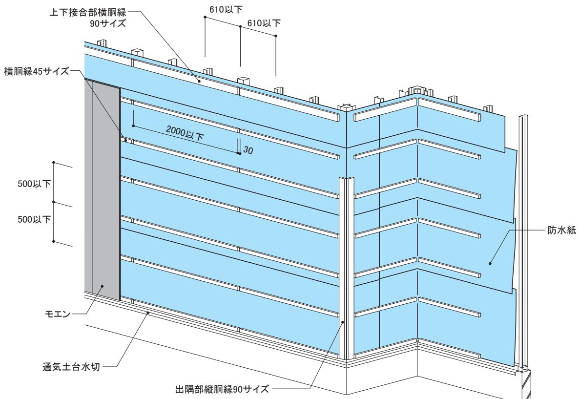
**小口処理** モエン縦張り下端小口面および切断小口面は、モエンシーラーを十分塗布し乾燥後、切断小口面が見える部分については専用補修液を、それ以外の部分はモエンシーラーを塗布します。
