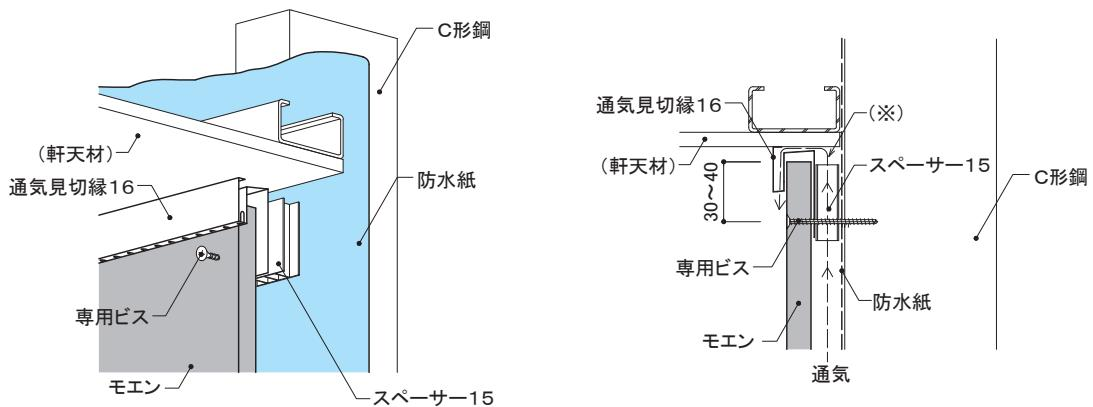
※通気がとれるよう、隙間を設けて施工してください。
