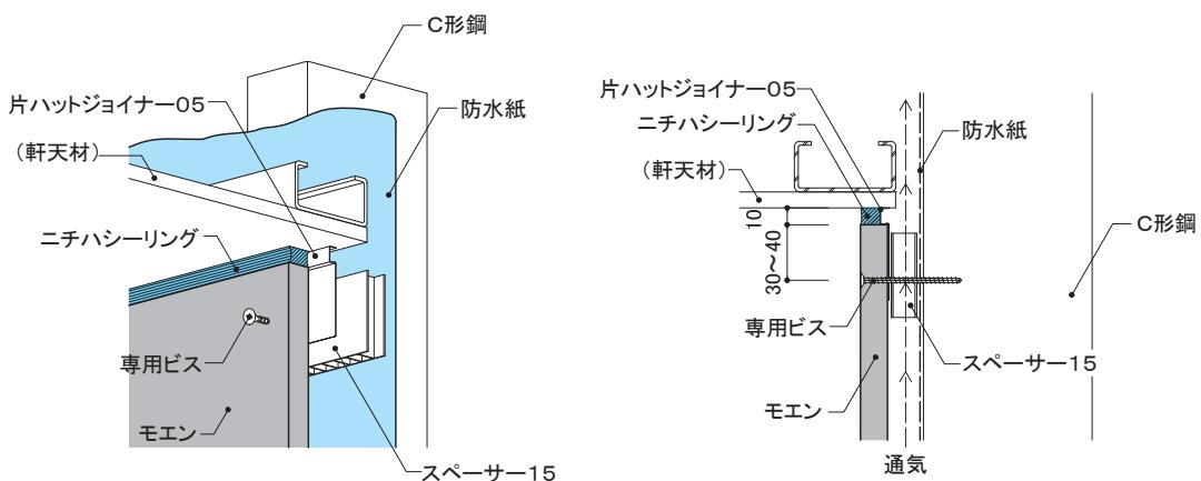
【ビス頭】補修用パテを埋め、硬化後、専用補修液を使用し、必要最小限の範囲に塗布します。
