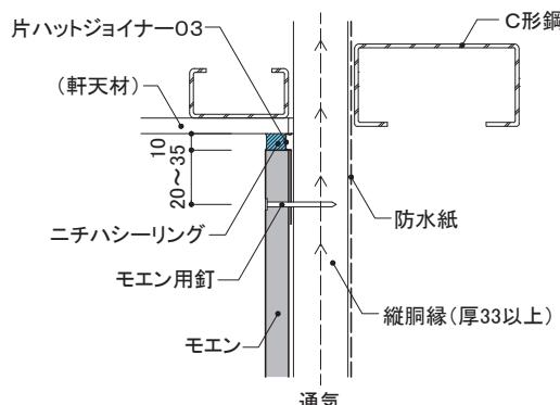
**釘頭** 釘頭の補修は目立つ箇所のみとし、専用補修液を使用し、必要最小限の範囲に塗布します。
