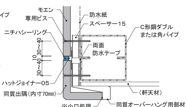
**小口処理** モエン縦張り下端小口面および切断小口面は、モエンシーラーを十分塗布し乾燥後、切断小口面が見える部分については専用補修液を、それ以外の部分はモエンシーラーを塗布します。
