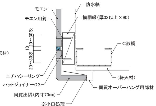
**小口処理** モエン縦張り下端小口面および切断小口面は、モエンシーラーを十分塗布し乾燥後、切断小口面が見える部分については専用補修液を、それ以外の部分はモエンシーラーを塗布します。
