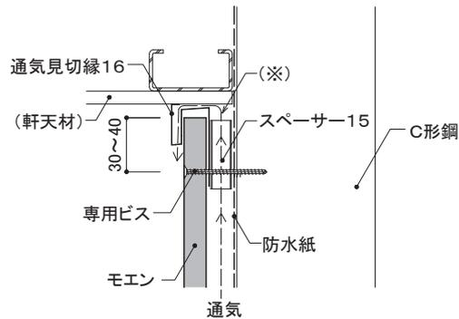
※通気がとれるよう、隙間を設けて施工してください。
