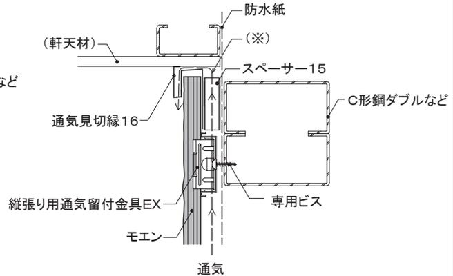
※通気がとれるよう、隙間を設けて施工してください。
