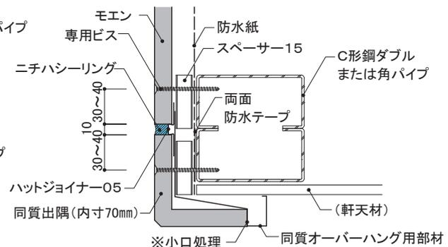
**小口処理** モエン縦張り下端小口面および切断小口面は、モエンシーラーを十分塗布し乾燥後、切断小口面が見える部分については専用補修液を、それ以外の部分はモエンシーラーを塗布します。
