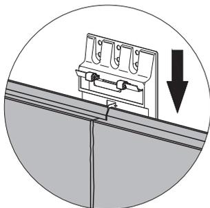
※通気留付金具EX左右接合部用は、実の間に上から差し込んで留め付けます。
