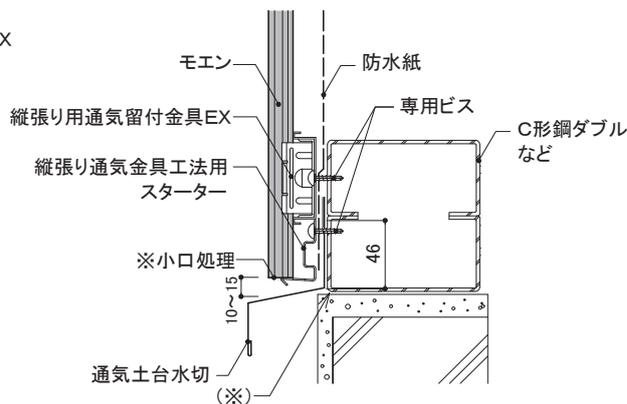
※ 吹き上げなどによる雨水浸入を防ぐため、止水処理が確実にされていることを確認してください。
