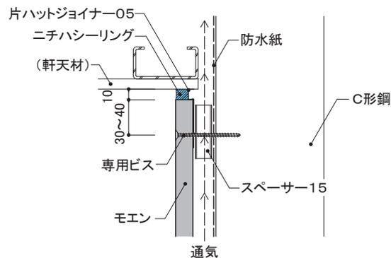
ビス頭 補修用パテを埋め、硬化後、専用補修液を使用し、必要最小限の範囲に塗布します。
