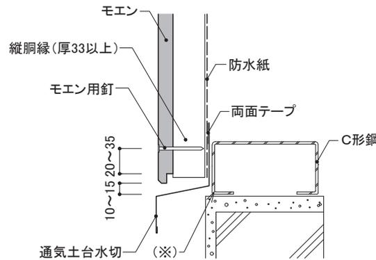
※ 吹き上げなどによる雨水浸入を防ぐため、止水処理が確実にされていることを確認してください。
