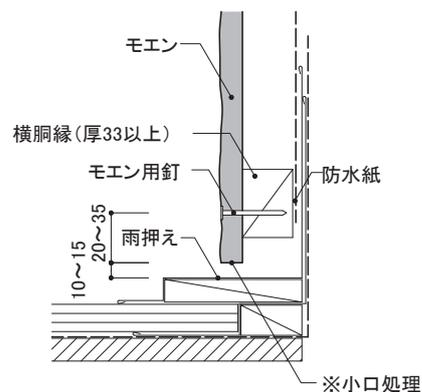
**小口処理** モエン縦張り下端小口面および切断小口面は、モエンシーラーを十分塗布し乾燥後、切断小口面が見える部分については専用補修液を、それ以外の部分はモエンシーラーを塗布します。
