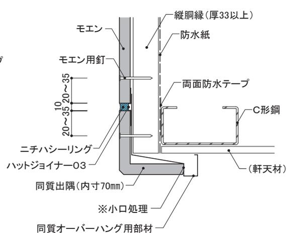
**小口処理** モエン縦張り下端小口面および切断小口面は、モエンシーラーを十分塗布し乾燥後、切断小口面が見える部分については専用補修液を、それ以外の部分はモエンシーラーを塗布します。
