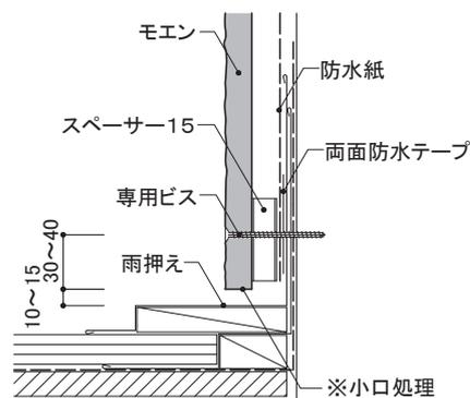
**小口処理** モエン縦張り下端小口面および切断小口面は、モエンシーラーを十分塗布し乾燥後、切断小口面が見える部分については専用補修液を、それ以外の部分はモエンシーラーを塗布します。
