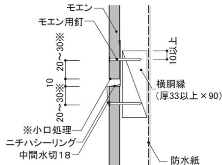
**小口処理** モエン縦張り下端小口面および切断小口面は、モエンシーラーを十分塗布し乾燥後、切断小口面が見える部分については専用補修液を、それ以外の部分はモエンシーラーを塗布します。
