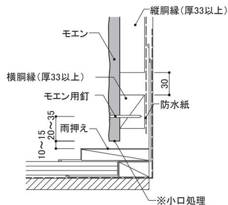
**小口処理** モエン縦張り下端小口面および切断小口面は、モエンシーラーを十分塗布し乾燥後、切断小口面が見える部分については専用補修液を、それ以外の部分はモエンシーラーを塗布します。
