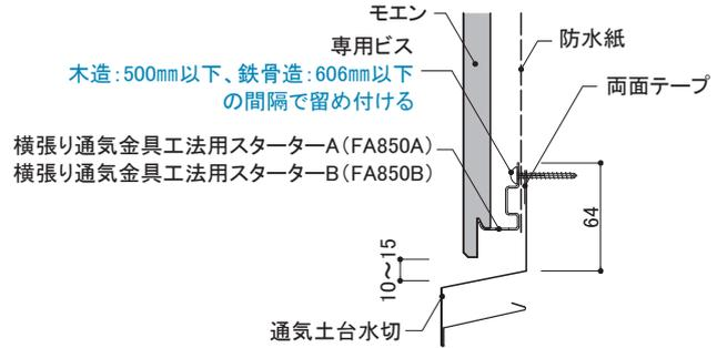
木造: 500mm以下、鉄骨造: 606mm以下の間隔で留め付ける
