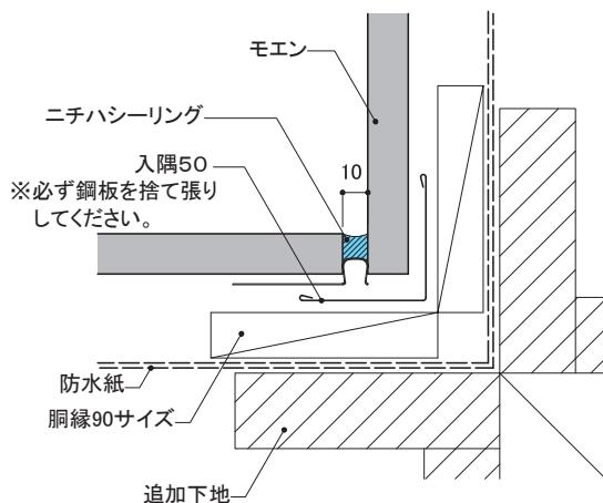
●縦張り釘打ち施工・縦張り胴縁金具施工の場合、横胴縁を通して施工してもかまいません。ただし、モエンの幅が1/2以下の割り付けとなる場合は、下図のように補強胴縁(縦胴縁)を取り付けてください。
