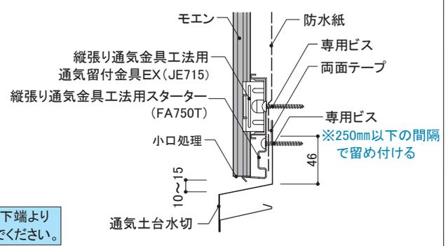
※250mm以下の間隔で留め付ける
