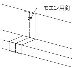
※接続の際には接続部分に捨てシーリングを施工してください。
