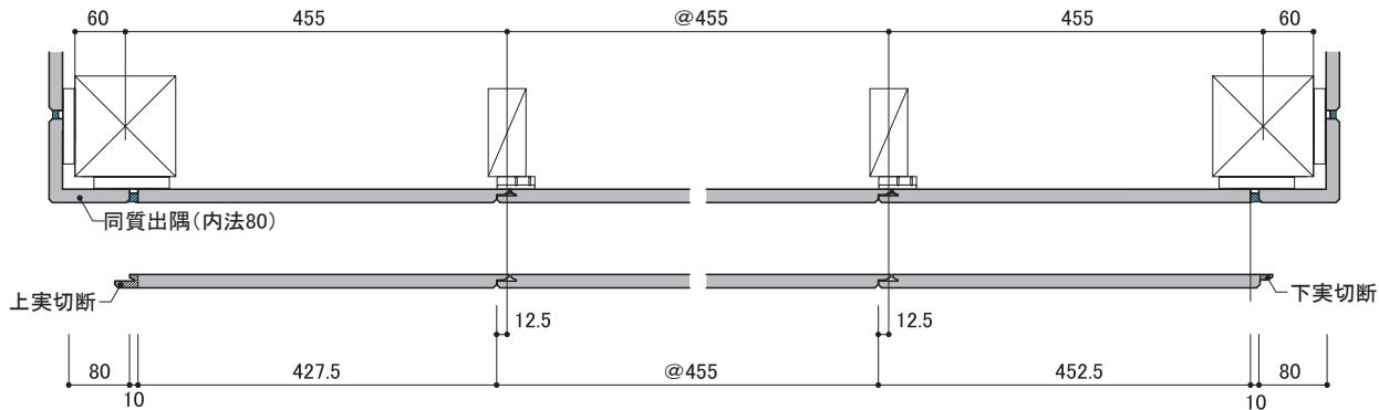
●上図の割り付けは内寸80mmの出隅を使用し、実を切断した施工例です。柱のサイズや合板などの施工により上図の寸法と異なる場合は、出隅の内寸を調整してください。
