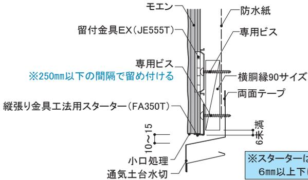
※250mm以下の間隔で留め付ける
