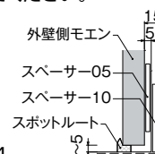
図4 通気金具工法の場合の縦断面図
