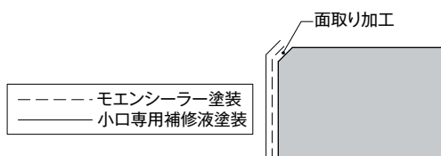
図4 モエン小口部の補修塗装
