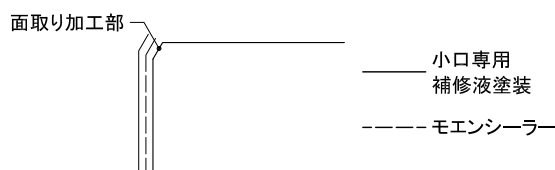
図4 COOLイルミオ小口部の補修塗装
