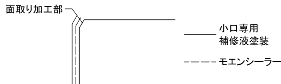
図2 同質出隅小口部の補修塗装
