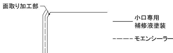
図4 COOLイルミオ小口部の補修塗装
