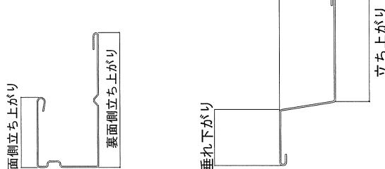
目地部材A 断面図(例)
