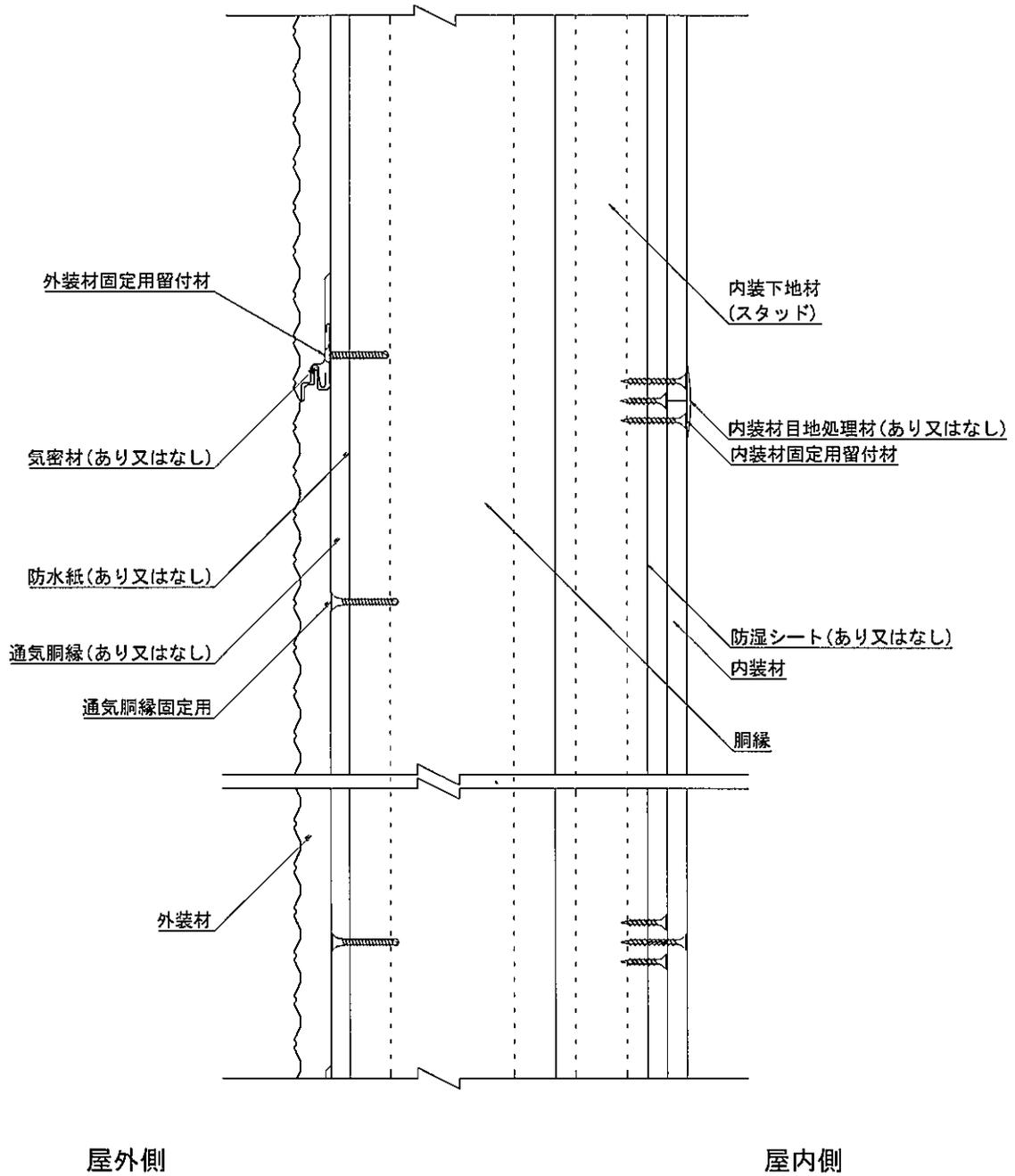
注) 寸法および材料構成は 2 および 3 のとおり
