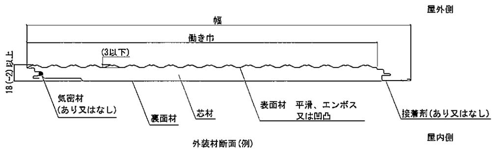
※断面欠損率(%)：8.7%以下(厚さ18での比)
