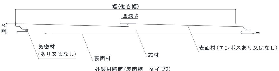
※タイプ1、タイプ2、タイプ3 共に断面欠損率(%) : 16%以下(厚さ18での比)
