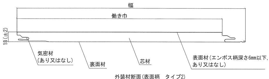
※タイプ1、タイプ2共に断面欠損率(%) : 16%以下(厚さ18での比)
